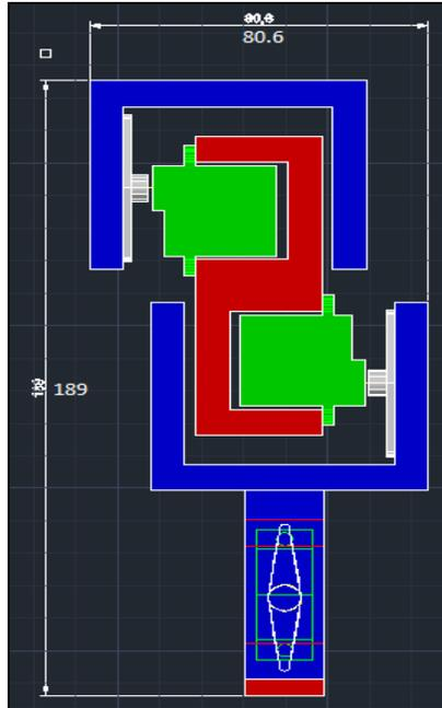
Figura 7. Diseño de la pierna del robot bípedo.
