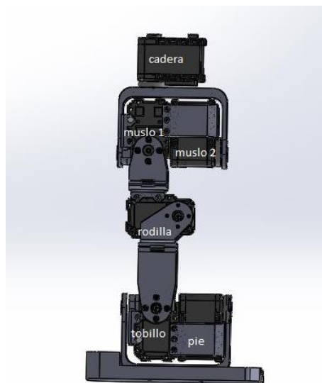
Fig. 4. Diseño de la pierna del robot bípedo.
