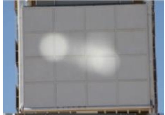
Figura 14. Imagen del rayo solar reflejado a 200 m de la torre.
