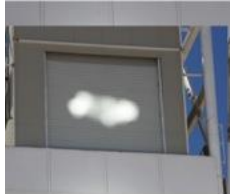
Figura 10. Imagen del rayo solar reflejado a 50 m de la torre.
