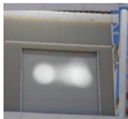
Figura 12. Imagen del rayo solar reflejado a 120 m de la torre.
