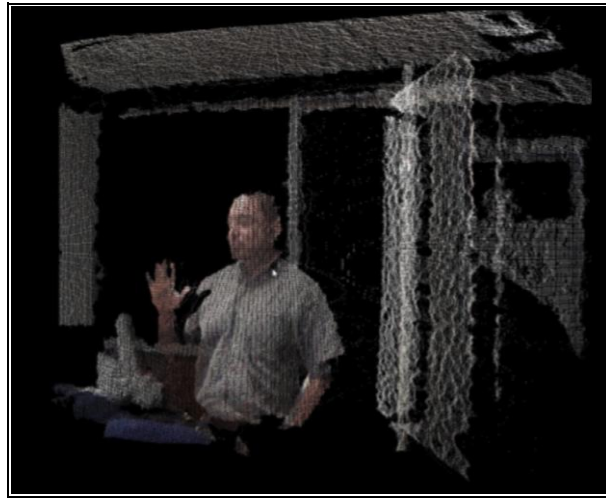
Fig. 2 Ejemplo de la reconstrucción 3d del ambiente con registro de imagen.
