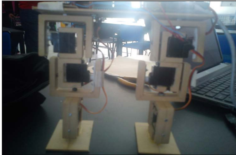
Figura 5. Robot bípodo de 6 grados de libertad.
