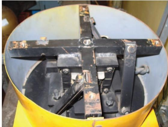
Figura 6. Vibrador electromagnético.
