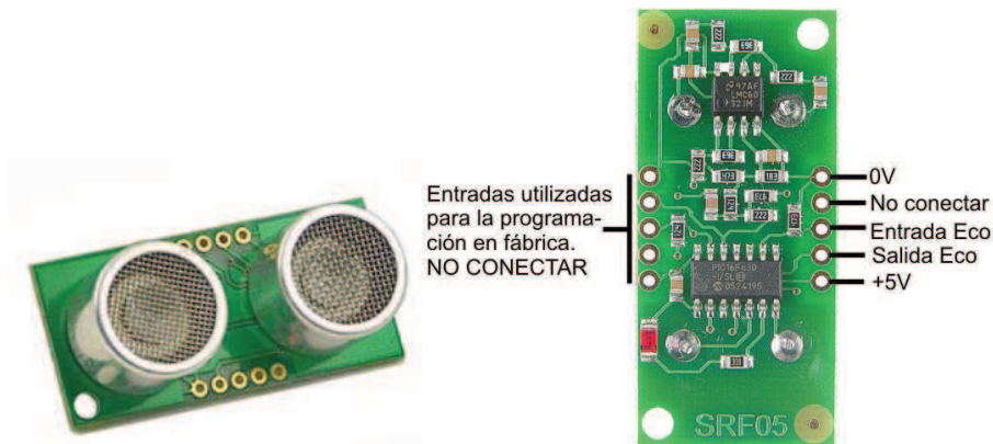
Figura 6. Sensor de distancia SRF05 y diagrama de conexión.
