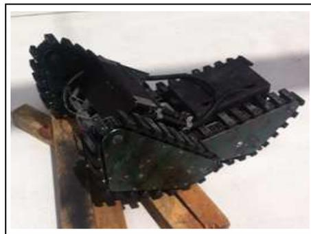
**Figura 2. Tracción con perfiles de neopreno que permite aumentar la fricción al contacto con el suelo**
