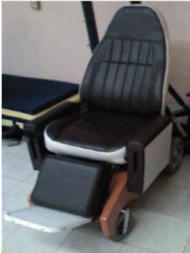
Figura 15 Prototipo de silla de ruedas para interfaz gestual.
