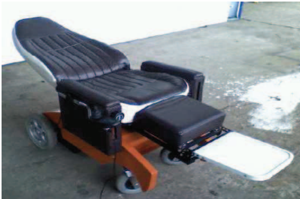
Figura 16 Prototipo de silla de ruedas en posición horizontal.
