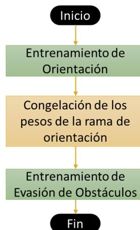
Figura 5. Proceso de entrenamiento del robot.
