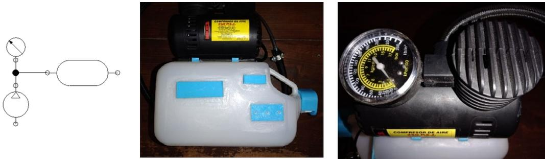
**Figura 6. Tanque de almacenamiento de aire comprimido y compresor. Elaboración propia.**
