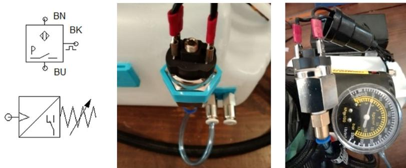
**Figura 7. Presóstato y su calibración. Elaboración propia.**
