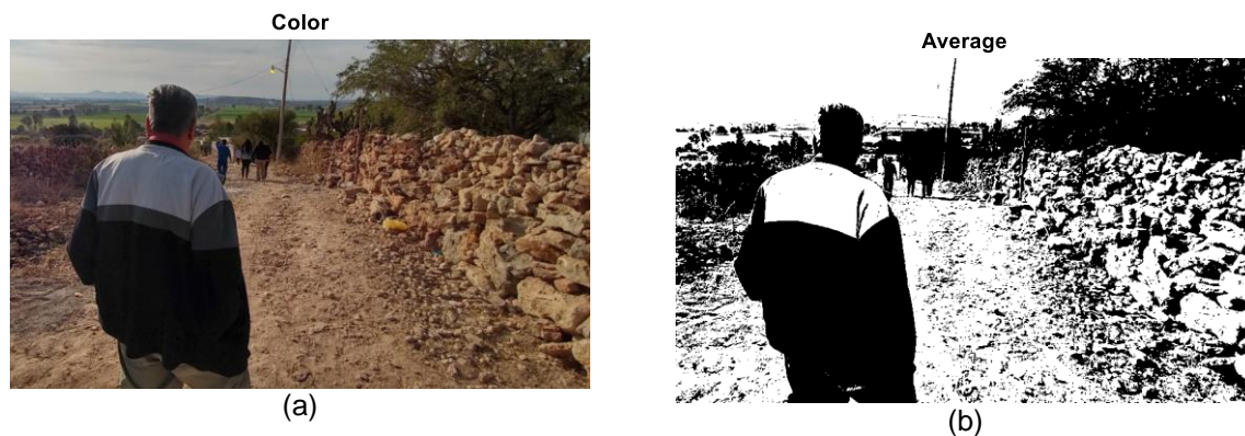
Figura 2. Imágenes binarias de acuerdo al método de escala de gris, con U=80 . (a) Original. (b) Método de promedio. (c) Método ligero. (d) Método de luminosidad con K_1=0.3 , K_2=0.6 y K_3=0.1 .
