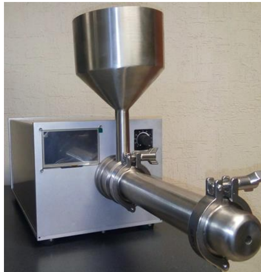
Figura 2. Prototipo de prensa de extrusión, con la pantalla táctil instalada en la esquina superior izquierda.
