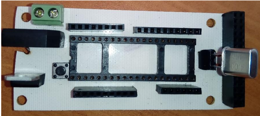
Figura 12. Tarjeta electrónica PIC18F4550 con los componentes soldados.
