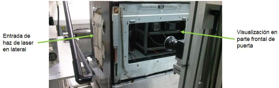
Figura 5. Disposición del equipo PIV para toma de imágenes
