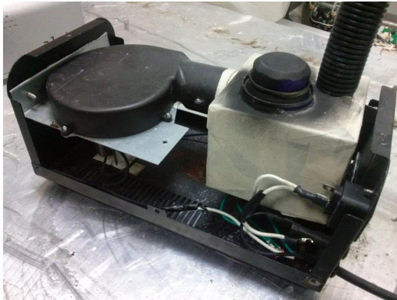
Figura 4. Sistema de inyección de polvos finos armado.
