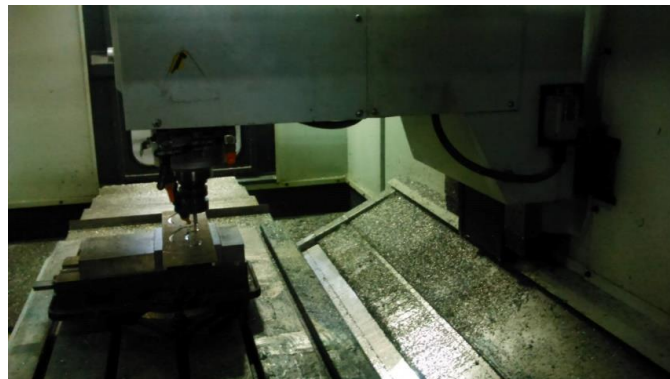
Figura 11. Piezas siendo maquinadas en el centro de maquinado CNC.
