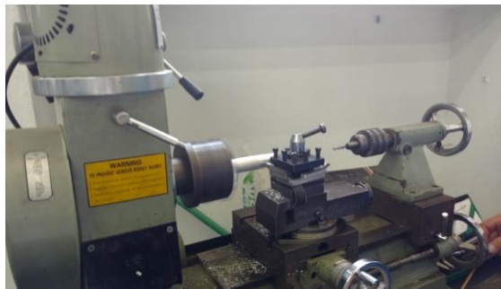
Figura 13. Pieza de aluminio siendo maquinada en el torno.
