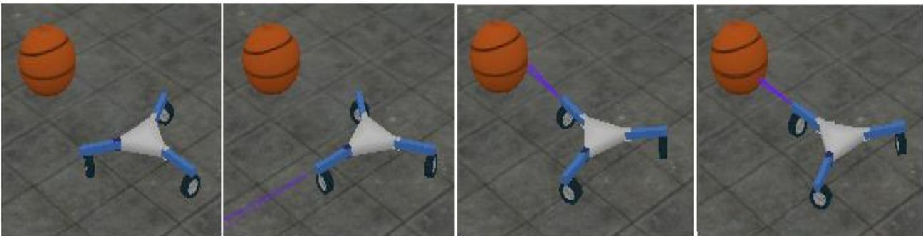
Figura 2. Secuencia de movimiento rotacional del robot.
