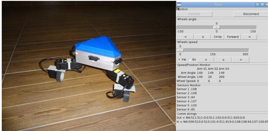
**Figura 6. Robot omni-direccional autónomo de 9 grados de libertad e interface de operación (izquierda). Interface de operación del robot (derecha).**
