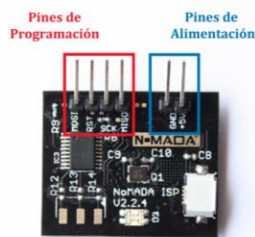
Figura 6 - Programador universal de Microcontroladores NoMADA. (2014). Recuperado de Manual de Conexión Eléctrica NoMADA ISP.
