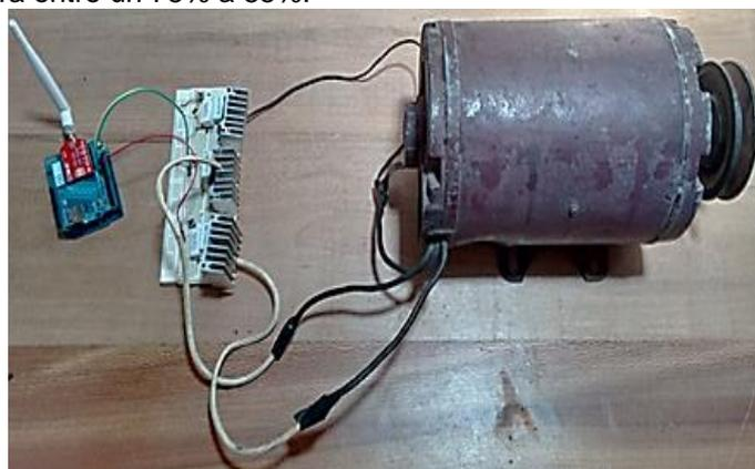
**Figura 15. Proyecto Completo Modulo Wi-fi, Arduino y Etapa de Potencia.**
