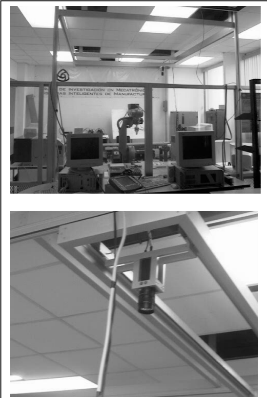
Figura 4.- Localización de cámara en sistema de posicionamiento X-Y.
