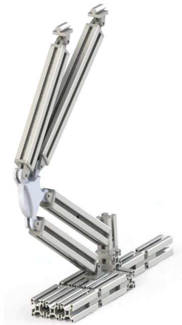
Figura 2. Pierna del robot TGK; la parte inferior es la que hará contacto con el suelo, el eslabón central funciona como rodilla y los dos juntas cilíndricas superiores representan lo equivalente a una cadera.
