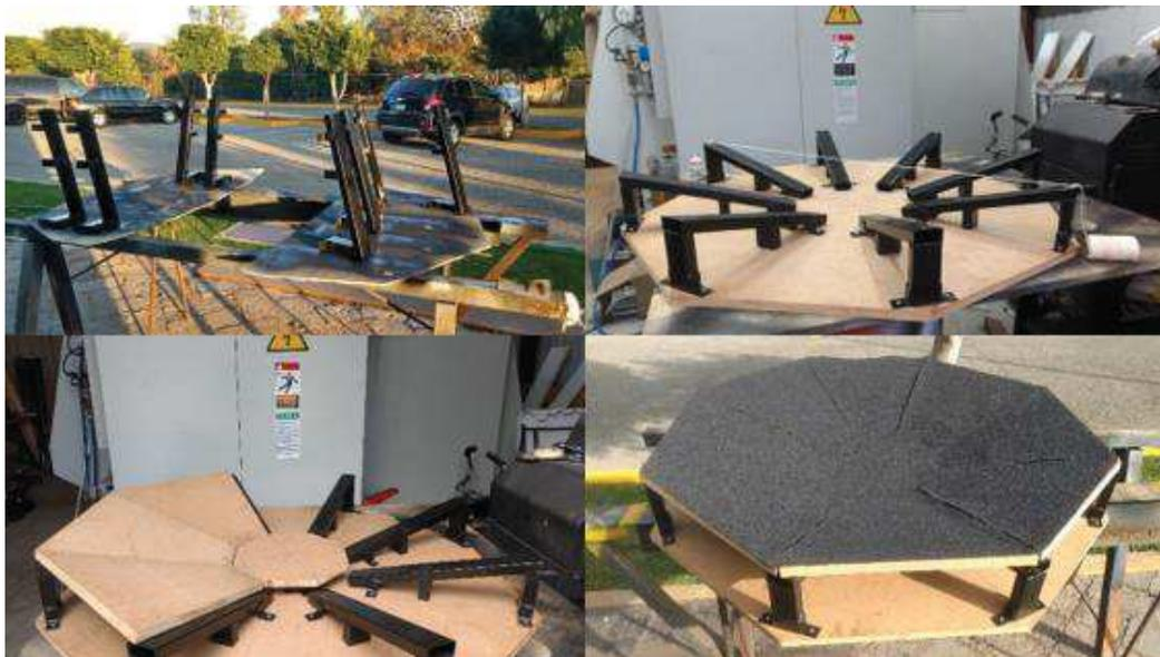
Figura 12. Montado y Terminado de la Base Cóncava.
