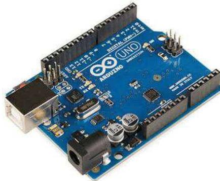
Figura 3. Placa Arduino
