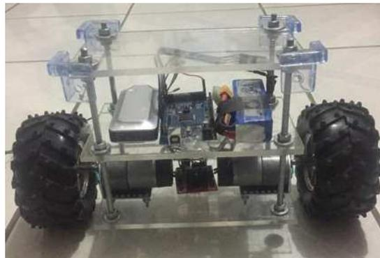
**Figura 7. Estructura de Robot Autobalanceado.**
