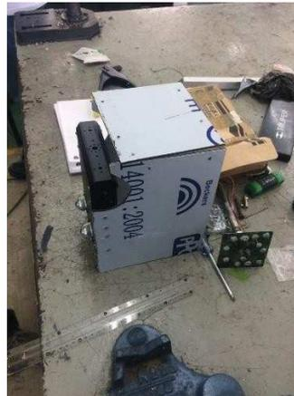
**Figura 11. Ensamble de piezas al chasis de aluminio.**
