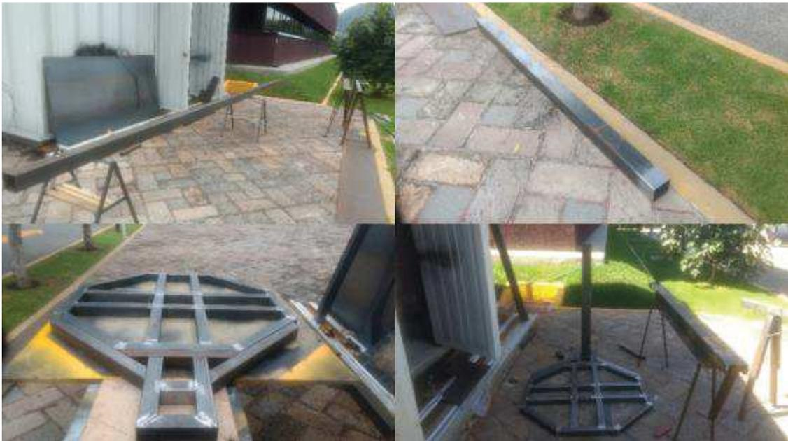
Figura 14. Pilar de Carga y Estructura para Soporte de la Base Cóncava
