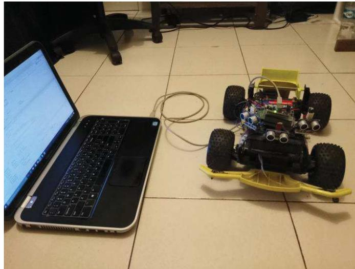
Figura 8. Implementación de 3 sensores ultrasónicos y 2 infrarrojos en el Robot Móvil.
