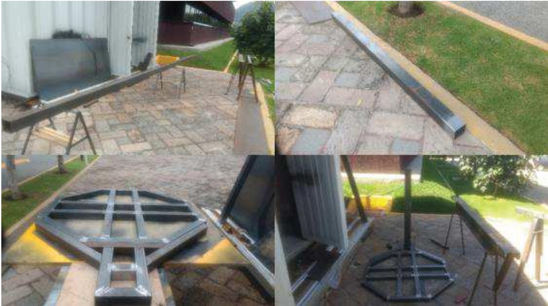
Figura 13. Estructura para Soporte de la Base Cóncava.
