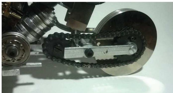
Figura 5. Ejemplo de transmisión de movimiento por cadena dentada y engranes.
