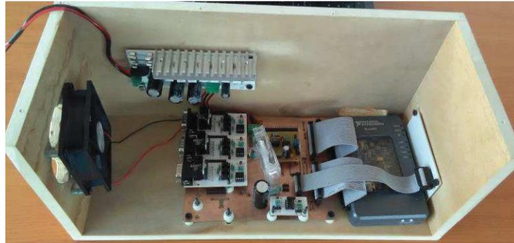
Figura 15. Tarjeta electrónica general actual en caja vista superior.
