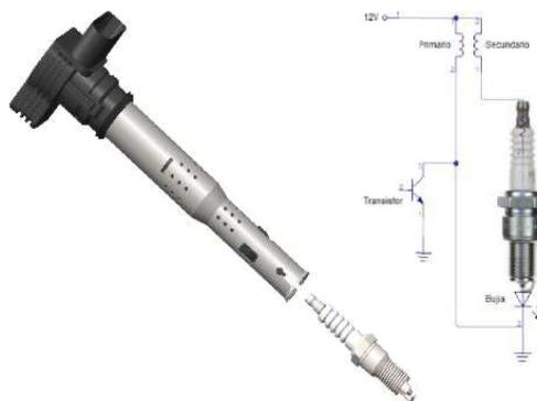
**Figura 10 Bobina de encendido tipo COP.**
