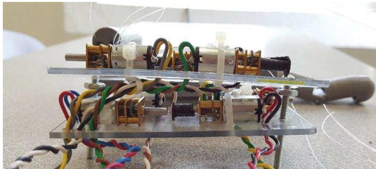
**Figura 20. Estructura base para los motoredutores.**
