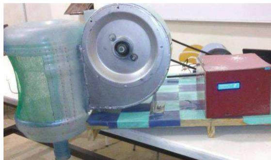
Figura 14. Prototipo de atrapaniebla.
