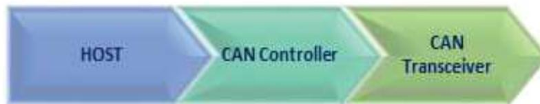
Figura 1 Configuración de un nodo CAN
