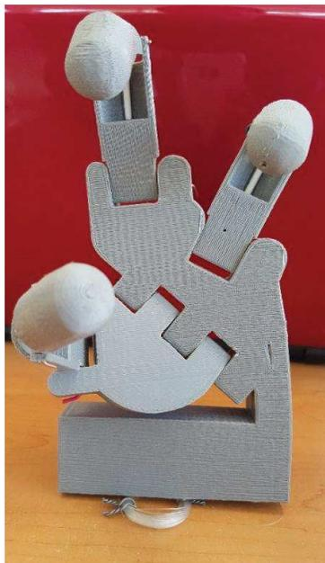
Figura 18. Vista frontal del prototipo para la mano ensamblado.
