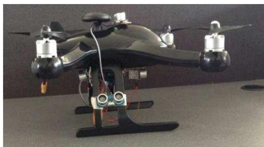
Figura 15. Implementación de los sensores en el UAV
