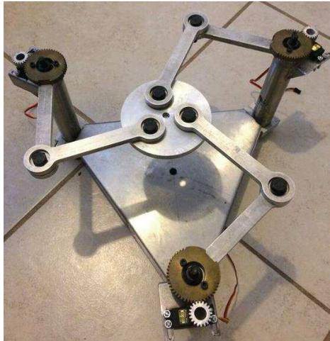
Figura 2.1 Robot paralelo plano
