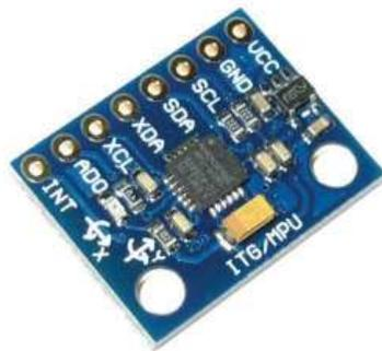
Figura 8. Sensor mpu6050.
