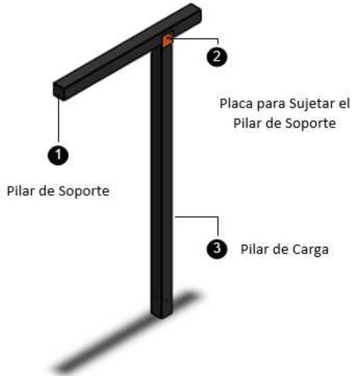
**Figura 9. Pilar de Carga y de Soporte**
