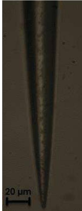
**Figura 2. Punta de fibra óptica, utilizada para el escaneo del microscopio de barrido de campo cercano desarrollado en este trabajo.**
