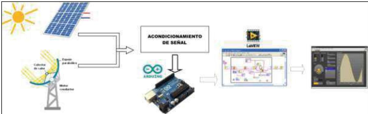
**Fig. 1. Esquema del sistema de adquisición de datos.**
