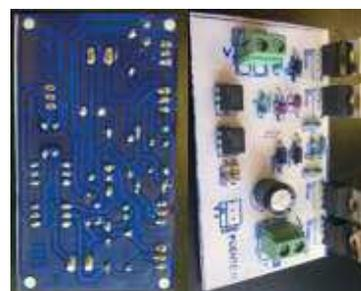
**Fig. 2 Vista superior e inferior del circuito del puente H con MOSFET.**
