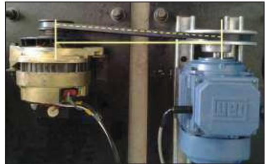
Fig. 4. Motor desalineado.
