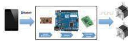
**Fig. 4: Elementos principales del control**
