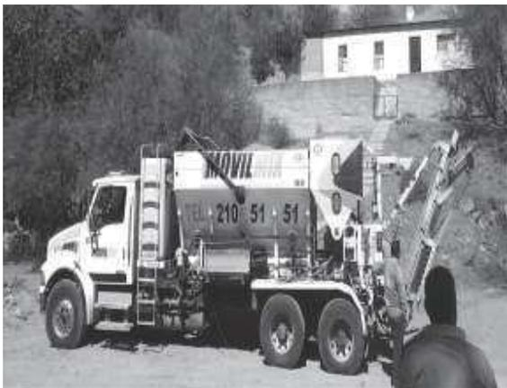
Figura 1. Dosificador Móvil de Concreto
