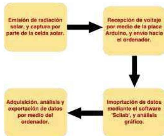
**Fig. 2. Diagrama a Bloques del Programa**
