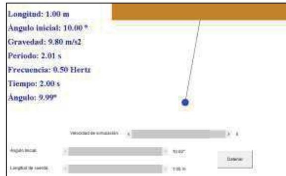
Fig. 7 Simulación en Applet
