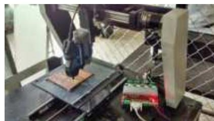
**Fig. 9. Fresado de una tarjeta con el prototipo.**
