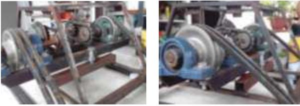
Fig. 8. Sistema de transmisión.
